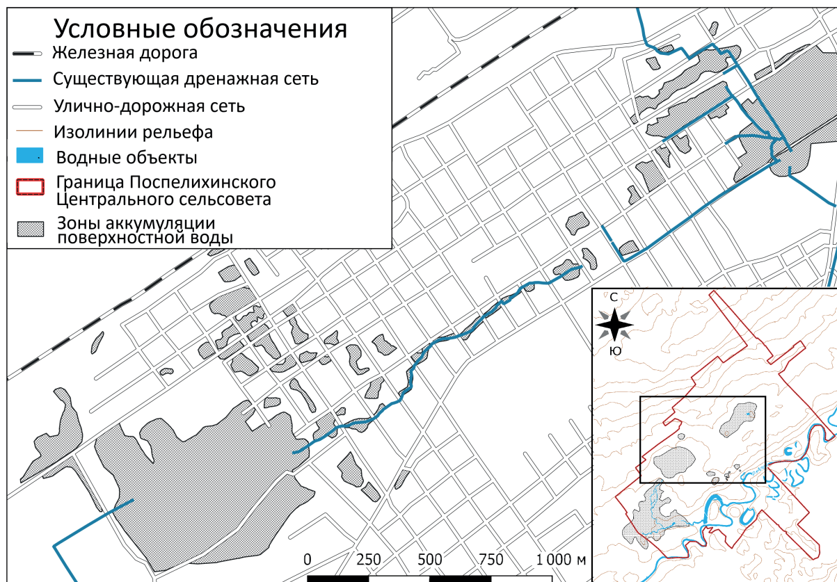
Рис. 2. Зоны подтопления и существующая дренажная сеть
