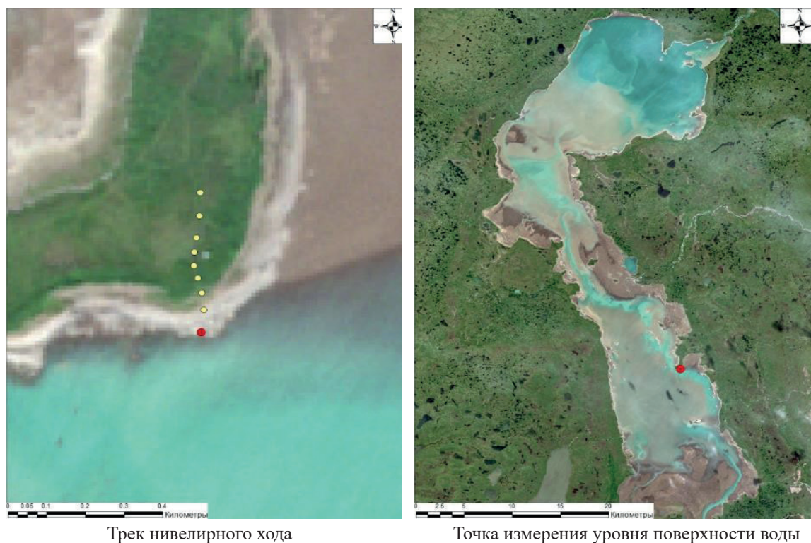
Рис. 3. Трек нивелирного хода и точка измерения уровня поверхности воды озера Пясино по измерениям 21 августа 2022 года. Подложка – GRB композит космоснимка Sentinel-2 от 17 августа 2022 г.
