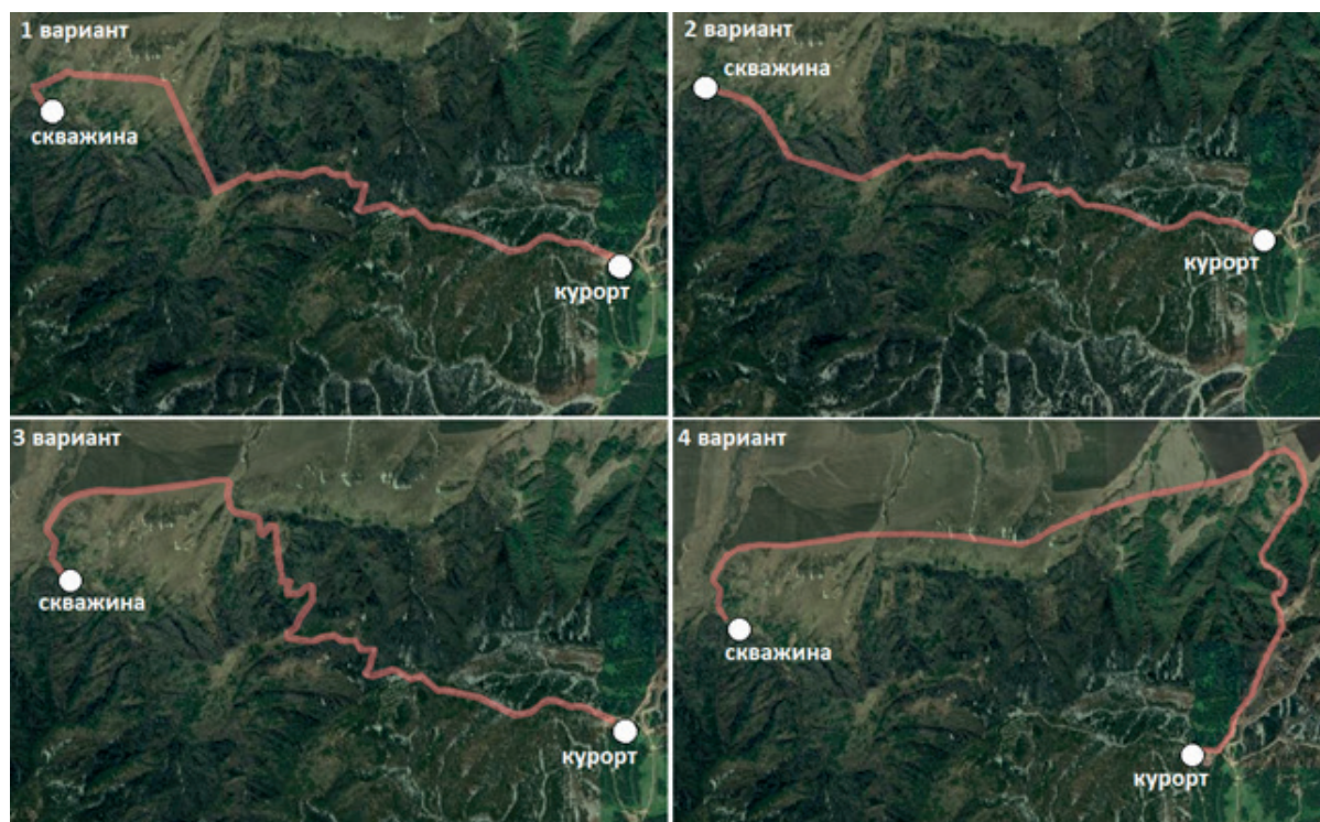
Рис. 2. Варианты прохождения трассы радонопровода Fig. 2. Probable routes of radon pipeline
