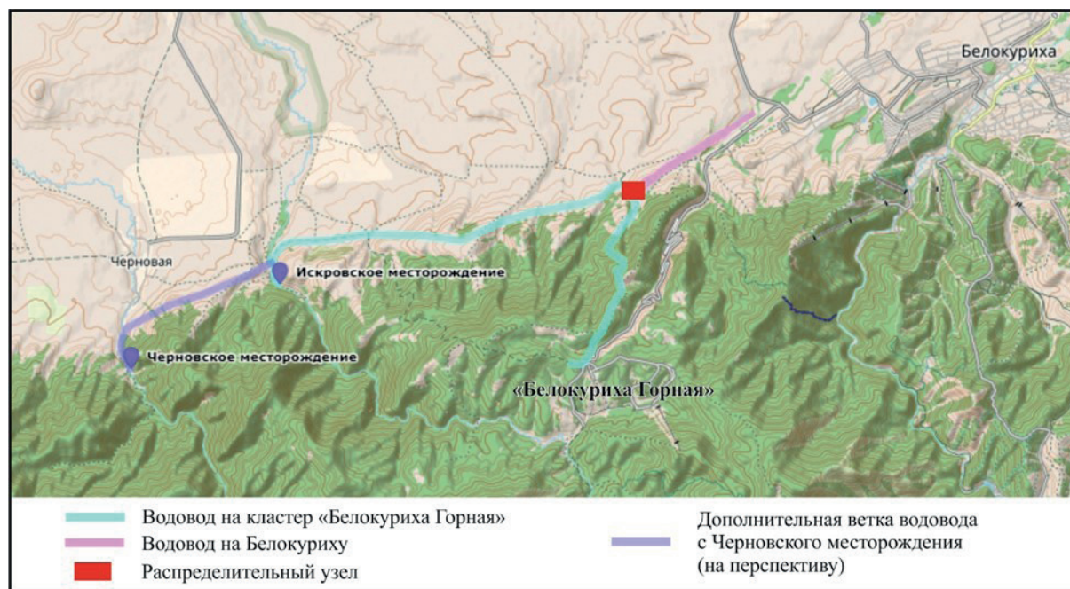
Рис. 4. Предлагаемая схема организации транспортирования воды с Искровского и Черновского месторождений
