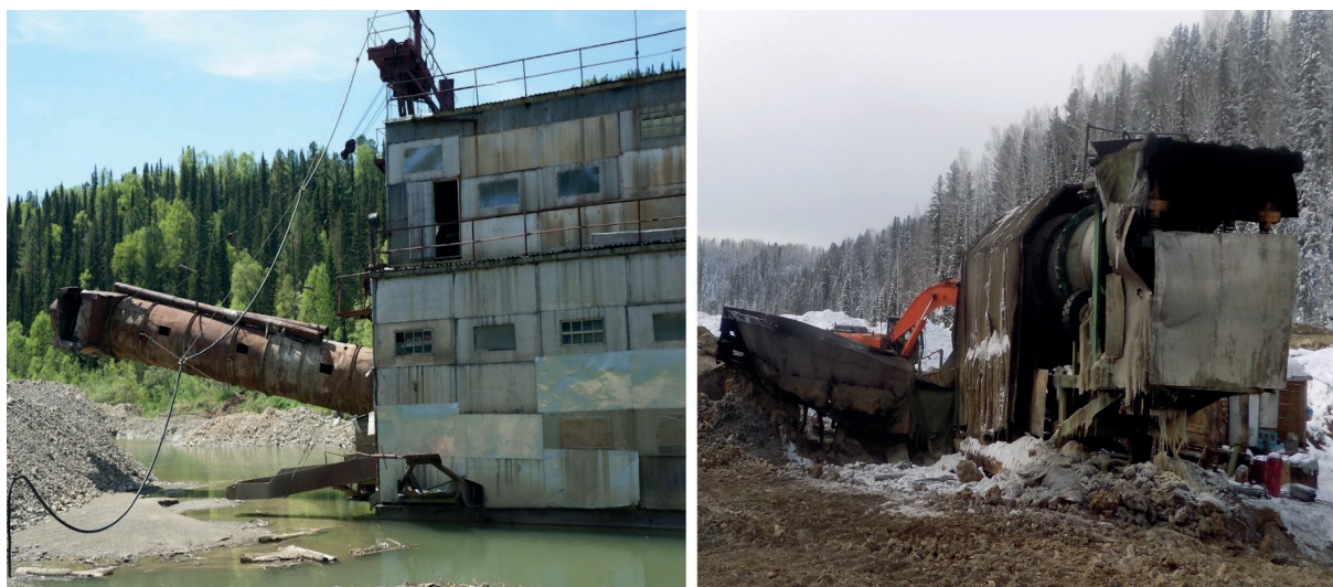
Рис. 1. Заброшенная драга в районе села Талон (слева) и работа промприбора на реке Андоба (справа) Fig. 1. Abandoned dredge in the area of Talon village (left) and the operation of the washing device on the Andoba river (right)
